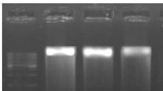
شکل ۱- DNA استخراج شده سه نمونه از ژنوتیپ‌های جو زراعی با روش CTAB. چاهک‌ها به ترتیب از چپ به راست شامل نشانگر اندازه ۱۰۰ bp DNA مربوط به رقم صحرا، لاین ۱۸ و لاین ۵۰ جدول ۲.
