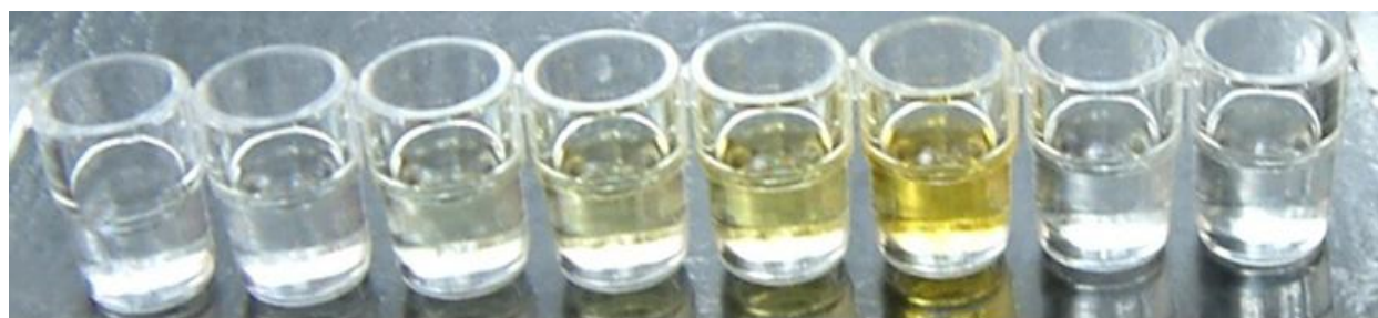
شکل ۶- رنگ‌گیری غلظت‌های مختلف انسولین. (۲ و ۱) شاهد؛ ۳ تا ۸) غلظت‌های مختلف انسولین به ترتیب ۱۰، ۵، ۲، ۱، ۰/۲ و صفر نانوگرم در میلی‌لیتر.
