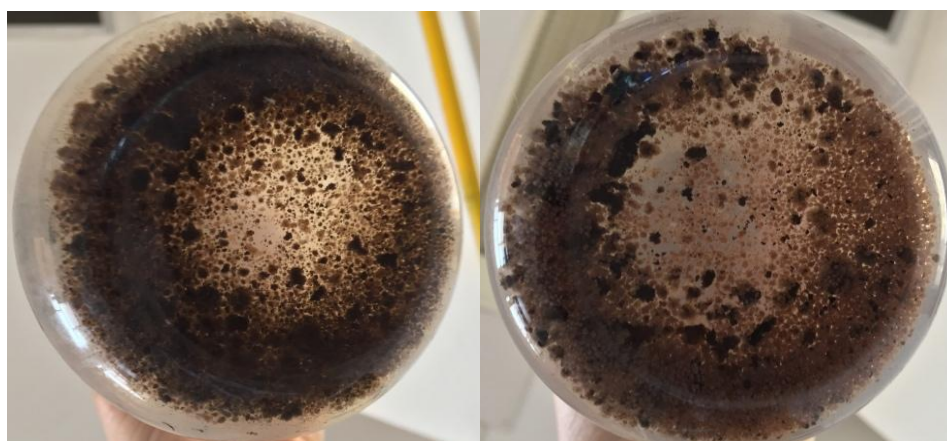
شکل ۱- از چپ نمای مقطع عرضی انتهای ارلن مایر ۲۵۰CC پیش از القای الیستور و راست همان نما بعد از القای الیستور
